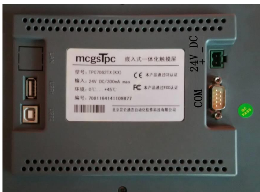
图 5-3 显示屏背面接线图
